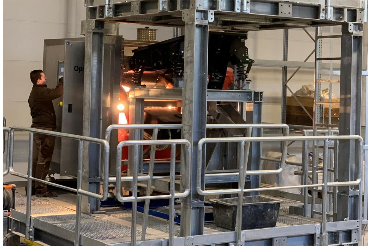
Freifallsortieranlage mit doppelter Detektion: NIR + Farbkamera
