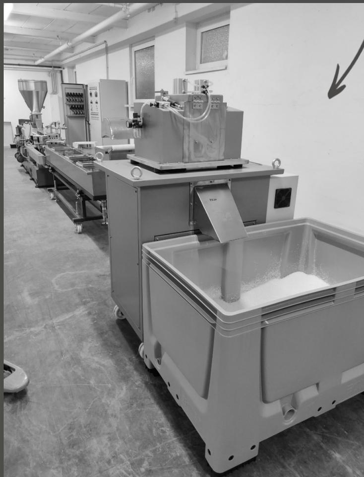
Doppelschneckenextruder für die Compoundierung
