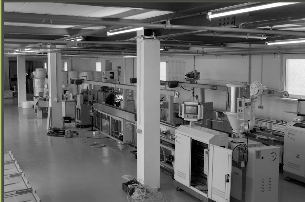
Produktionsanlage mit zwei 17 Meter langen Filament-Extruder-Linien
